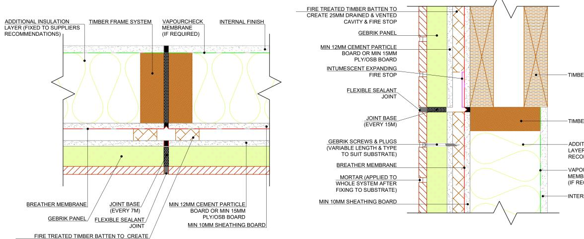
25MM DRAINED & VENTED CAVITY & FIRE STOP
